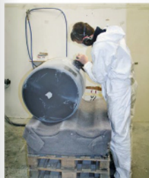
„Filterherstellung ist ein bisschen wie Kuchenbacken“, meint Markus Weber. Oben sieht man, wie ein Mitarbeiter das Glasfaser-Harz-Gemisch auf den Filterdeckel aufsprüht. In kleinen Spezialräumen (unten) werden die Filter abgeschliffen. Die abgeschliffenen Partikel werden sofort abgesaugt.
