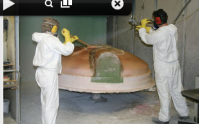
„Filterherstellung ist ein bisschen wie Kuchenbacken“, meint Markus Weber. Oben sieht man, wie ein Mitarbeiter das Glasfaser-Harz-Gemisch auf den Filterdeckel aufsprüht. In kleinen Spezialräumen (unten) werden die Filter abgeschliffen. Die abgeschliffenen Partikel werden sofort abgesaugt.
