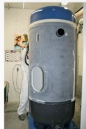
„Filterherstellung ist ein bisschen wie Kuchenbacken“, meint Markus Weber. Oben sieht man, wie ein Mitarbeiter das Glasfaser-Harz-Gemisch auf den Filterdeckel aufsprüht. In kleinen Spezialräumen (unten) werden die Filter abgeschliffen. Die abgeschliffenen Partikel werden sofort abgesaugt.
